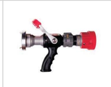
**203808** FIB DEBOLITE 235 Voll-Spektrum GFK - Hohlstrahlrohr mit Storz C Kupplung, nach DIN EN 15182-2:2010-04, für die Brandbekämpfung, einstellbare Durchflussmenge 60-130-235 l/min und Strahlform, aus speziellem Kunststoff für Sicherheitsanwendungen, besonders leicht, günstig und belastbar, Gewicht 2,12 kg
