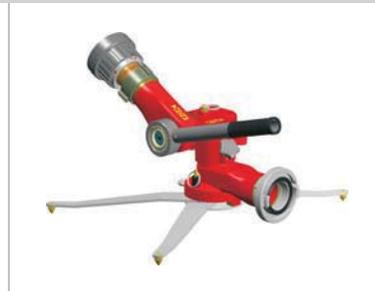
**204130** POKet-Monitor mit Oszillation bis max. 2.000 l/min., einstellbarer Schwenkbereich, komplett mit Düse stufenlos von Voll- auf Sprühstrahl (110°) einstellbar 800/ 1.050/ 1.300/ 1.600 l/min., aus eloxiertem Aluminium, Wurfweite: 43 m Vollstrahl 29 m Sprühstrahl, Anschluss: Kupplung Storz-B, mit Druckmanometer, Sicherungsseil, Gewicht ca. 12 kg
