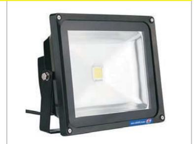
**482025** LED-Flutlichtstrahler 50 W, 230 V mit 10 m Anschlussleitung H07 RN-F3G 3x1,5 qmm mit Schuko-Stecker DIN 49443 Schutzart IP 68, mit Aufnahmhülse für Zapfen 30 mm ø nach DIN 14683, Feststellschraube als Sterngriff, Lichtstrom ca. 4.500 Lumen, Gehäuse HxBxT 290x155x345 mm, Gew. ca. 5,3 kg
