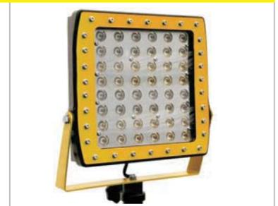
**482064** LED-Flutlichtstrahler 150 W, 12/24 V Kfz mit 5 m Anschlussleitung, Schutzart IP 65, Gehäuse aus Alu, Schwenkbügel aus Edelstahl, mit Norm-Aufsteckzapfen 30 mm DIN 14640, Feststellschraube mit Sterngriff, Hochleistungs-LEDs mit gleichzeitig geringem Stromverbrauch und hoher Lebensdauer, stoss- und vibrationsunempfindlich, Lichtleistung ca. 18.000 Lumen, Gehäuse HxBxT 350x350x125 mm, Gew. ca. 5,5 kg
