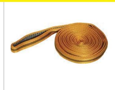
**830920** Bandschlinge 1,50 m lang, Umfang 3,00 m, nach EN 566 & EN 354, hochfeste Bandschlinge, Bruchlast 22 kN, zusätzlich dynamisch geprüft, Bandschlinge ca. 20 mm breit
