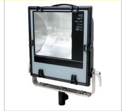
**482102** HID-250 Metalldampfentladungslampe, ersetzt mit nur 250 W bis zu 4.000 W Halogen-Lichtleistung, Spannung 230 V, Leistung 250 W, Gehäuse schutzisoliert IP 66, erhitzt sich auch nach längerer Brenndauer nicht sehr stark, mit 10m Anschlussleitung & druckwasserdichtem Stecker IP 68, die Aufnahme nach DIN 14640 erlaubt eine universelle Befestigung auf Brücken und Stativen mit Normzapfen nach DIN, mit rastbarem seitlichem Bügelsteller, Maße: 425x450x170 mm, ca. 11 kg
