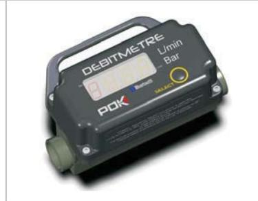
**211773** Durchflußmengenmeßgerät DN 80 B aus Alu-Legierung, eloxiert, rostfrei mit integrierter, aufladbarer Batterie für 8 Betriebsstunden, LED-Anzeige, Druck: min. 0,1 bar / max. 17 bar, Meßgenauigkeit: +/- 0,05 bar, Ein- und Ausgang: Kuppl. B-Storz, im Transportkoffer mit Bedienungsanleitung, Durchfluß: 175 bis 2.510 l/min. / 10.5 bis 150 cbm/h, Gewicht ca. 7,4 kg
