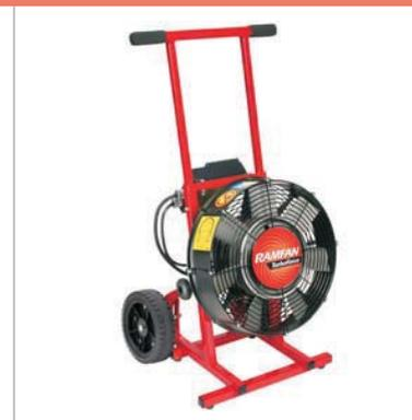
**530444** Elektro-Lüfter EV 420, 7-blättriger polymer TurboForce Rotor für bessere Performance 40 cm Durchmesser, E-Motor 240 V 10A 1.5 PS, elektron. Regelung des Anlaufstroms, Luftleistung AMCA 17.143 cbm/, Neigungswinkel 0° und 20° verstellbar, Maße: HxBxT 580x444x470 mm, Gewicht 31 kg
