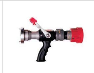
**203821** FIB DEBOLITE 400 Voll-Spektrum GFK - Hohlstrahlrohr mit Storz B Kupplung, nach DIN EN 15182-2:2010-04, für die Brandbekämpfung, einstellbare Durchflussmenge 60-130-235-400 l/min und Strahlform, aus speziellem Kunststoff für Sicherheitsanwendungen, besonders leicht, günstig und belastbar, Gewicht 2,25 kg
