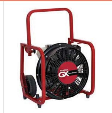
**530435** Drucklüfter GX 350 Power Stream Technologie, mit 4-Takt Honda 4,5 kW/5,5 PS Motor. Luftfördermengen: nach AMCA 240 – 33.830 m³/h, Arbeitsgeräusch in 3 m Entfernung 96 dB, 2 besonders breite und große Transporträder, 2 Standfüße, automatische Einstellung des optimalen Neigungswinkels beim Hochziehen des Tragegriffs, Feineinstellung zwischen +10° und +20°, Maße: HxBxT 550x550x500 mm, Gewicht ca. 39 kg
