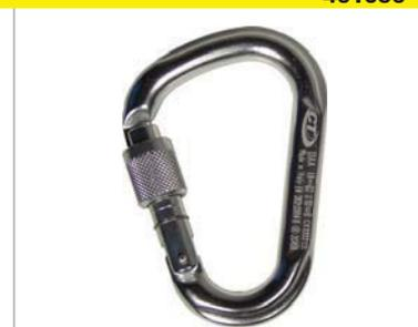
**461056** HMS-Karabiner CT Screw nach EN 362, Bruchlast längs 23 kN, quer 10 kN, offen 9 kN, Schnapperöffnung 23 mm, Verschlusssystem Catch-Free mit Schraubverschluss, ca. 86 g
